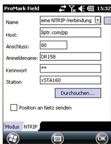
ANMERKUNG: Sie können beliebig viele Ntrip- und Direct-IP-Konfigurationen anlegen. Jede Konfiguration kann durch Markieren des Namens (Feld **Name**) aktiviert werden. Aufgerufene Konfigurationen können über die Schaltfläche **Entf** gelöscht werden.
